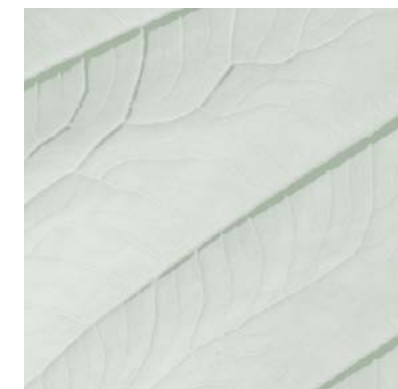
Composiet-kunststof 'Raficlad' met nerf-structuur als omkleiding van de onderzijden van de brugdekken
